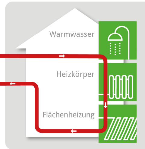
Wärmeverteil- und Speichersystem
